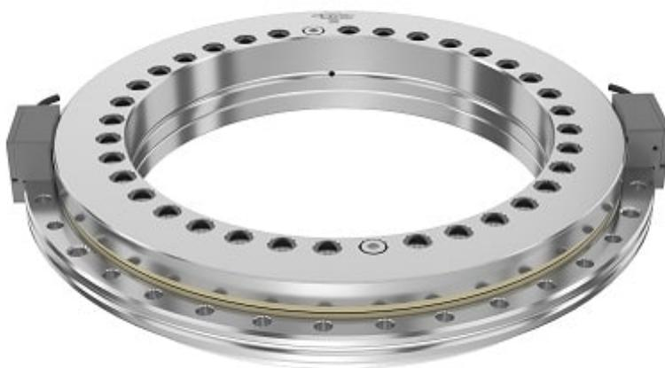
Il cuscinetto **Unitec RTB ABS** è dotato di un **sistema di misura angolare assoluto integrato** con encoder induttivo che permette di rilevare la posizione in tempo reale, restituendo il miglior valore di posizionamento possibile senza essere influenzato dalla presenza di eventuali impurità o di campi magnetici.
